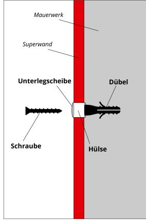
Durch das Reindrehen der Schraube wird der Dübel fest im Mauerwerk verankert.
